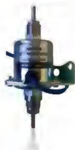
定容積形電磁ポンプは、プランジャ・ピストンの往復する距離（ストローク長）を構造により規制することによって、一定の容積変化が繰り返され、背圧変動などの外乱影響を受け難い特徴をもっています。
