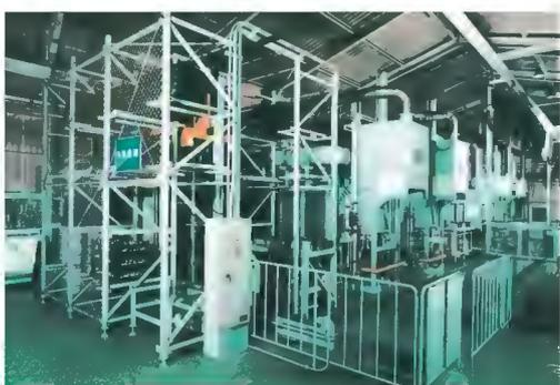
当社熱処理設備全自動監視システムは、洗浄や各熱処理炉の処理条件の設定変更まで、全てのプロセスをCRT画面とキーボード操作による対話形式で行えるハイテクノロジーシステムです。処理品をセットし、処理パターンを設定しさえすれば、後は一切が全自動。無停電装置の標準装備による無人化対応の実現や、作業環境の改善、さらに高品質化が図れるなど、その実力を如何なく発揮しています。
