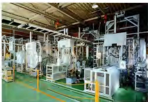
高速度鋼、ダイス鋼、ステンレス鋼の焼入、焼戻し、時効処理、ロー付等……ガス冷却噴射ノズルは、上下に配置されているので、ガスが均一に流れ焼入れ歪が少ない。最大3Barの高圧ガスを高速に循環させるため、急速冷却ができ高速度鋼及び大物ダイカスト金型、プレス金型の熱処理に最適です。
