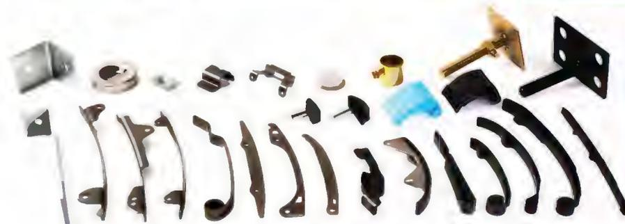
SAPH440、SPFH590の2.6t ~ 5.0tの材料を主に使用した部品製作を行っています。また輪郭精度を維持したR形状品の製作を得意としています。
