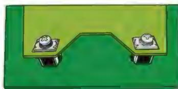
ねじ端子+アース端子での基板間の接続
