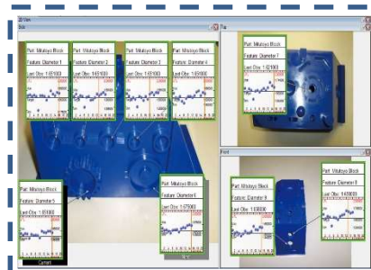
ワークの図面や写真を背景に測定項目を吹き出し形式で表示
