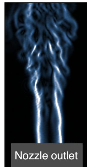
偏光カメラを用いた時空解析による透明物体の密度変化測定: (左) 光学系, (右) 測定結果
