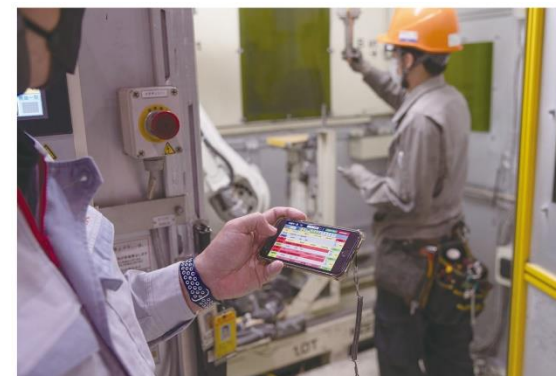
作業内容は現場でスマホから入力。メモを取って転記する必要がなくなり、作業時間も正確に記録できるようになった
