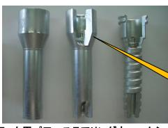
全長 207mm 外径  $\phi$  58mm 同軸度 0.05
