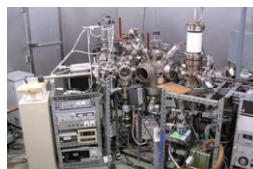
図1 超高真空中一貫 (in situ) 試験装置
