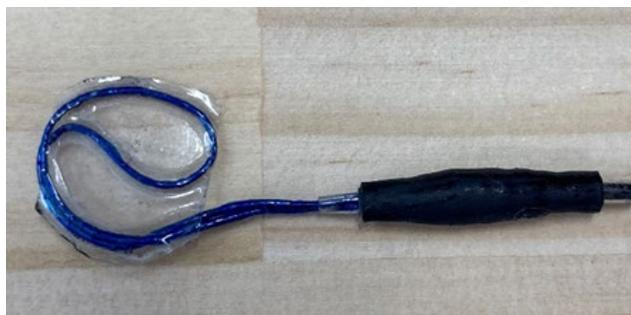
極細径ピエゾワイヤセンサ計測部
