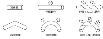
空気圧ソフトアクチュエータの初期形状や動作 方向を決める構造または機構が最初から空気 圧ソフトアクチュエータに組み込まれている。 アクチュエータ素材よりも剛性の高い弾性材 料と一体化して作製されており、あらかじめ設 計された動作しかできない。
