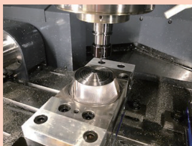
金型製作の様子（切削加工）
