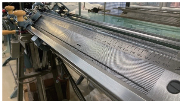
川口製造工場 手動横編み機を使用して、編立・リンクン・縮絨まで、すべて職人が手作業で行う
