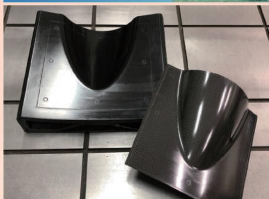
(左) 成形型、CFRP製品
