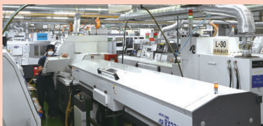
恒温工場を備え、ミクロン単位の超精密加工に対応するため、1年を通じて±1.0℃で管理している
